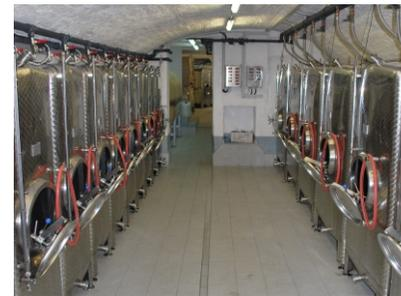
Nun geht es ein Stockwerk tiefer in unseren Weinkeller mit wunderschönem Gewölbe. Dicht an dicht stehen die Edelstahlfässer gereiht, um bis zu 200.000 Liter Most und Wein zu lagern. Jedes Fass ist mit einer eigenen Kühlvorrichtung ausgestattet, um die Temperatur während der Gärung niedrig zu halten - so werden Aromen und Qualität geschützt.
